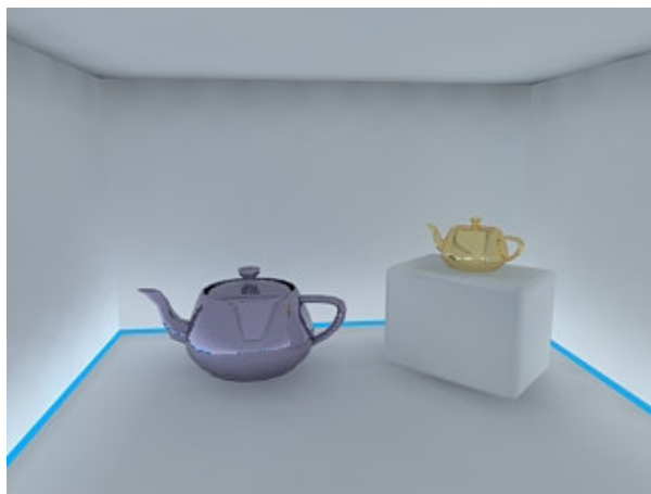
Obr. 3 - Materiál ALO s hodnotou Self-Illum=100 (viz obr.1) a Luminance Scale = 5000 , zapnuta Logaritmická expozice
