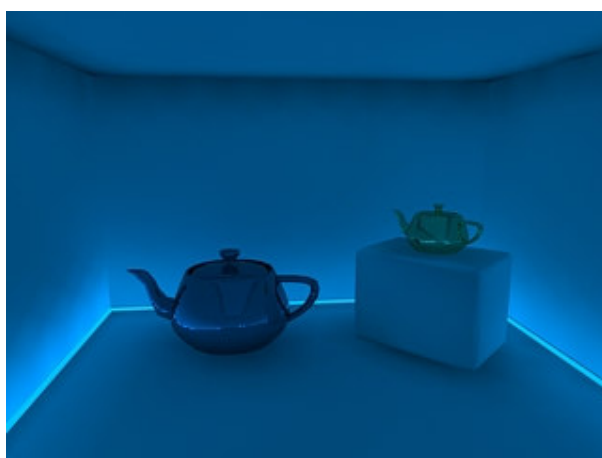
Obr. 6 - Materiál ALO s difúzní barvou ve slotu Self-Illum (viz obr. 2) a Luminance Scale = 2000 , zapnuta Logaritmická expozice
